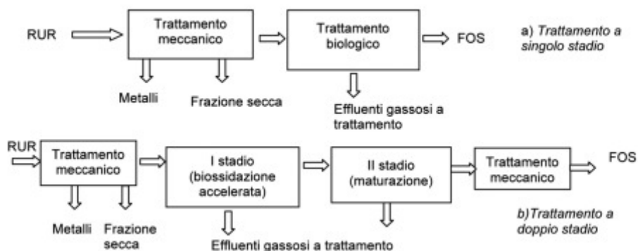
Figura 3: schema di principio di TMB di biostabilizzazione a singolo (a) e a doppio stadio (b)
